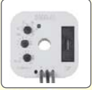
SMR-K супер-мультифункциональное реле в монтажную коробку, под кнопку/выключатель. 3-проводное подключение (без Нейтрала). Вход: может быть параллельно подключен светодиод или эконом.лампы.
