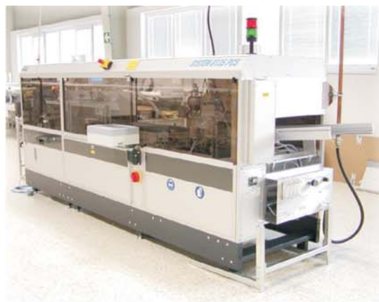
8) После ручного классического набора деталей следует пайка паяльной линии SEHO 8135-PCS, которая поддерживает технологию пайки "lead free". Благодаря модульному IR разогреву эта паяльная линия позволяет обработать DPSи термочувствительными деталями на верхней стороне DPS. Паяльная линия оборудована LW жиклером пайки и Delta жиклером. Это позволяет провести высококачественную пайку.
